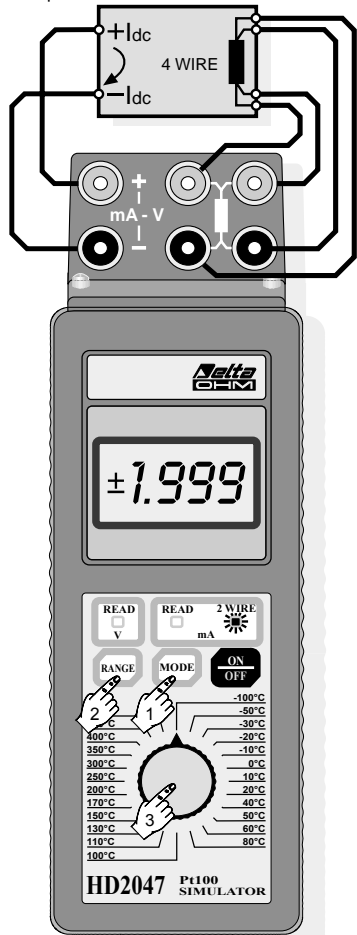
Fig. 3 Verifica di un trasmettitore passivo con ingresso Pt100 - Testing a passive transmitter with a Pt100 input - Étalonage d'un transmetteur passif avec entrée Pt100 - Nachprüfung eines passiven Messumformers mit Pt100 Eingang - Control de un transmisor pasivo con entrada Pt100
