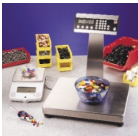
Sistemi di conteggio pezzi: una bilancia DC collegata ad una bilancia di precisione Ohaus Explorer™
