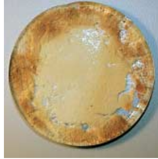
Surriscaldamento locale del campione con una lampada alogena
