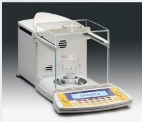
Fig. 3. Trappola di evaporazione nella bilancia semimicro ME 215P-SD con una protezione contro le correnti d'aria di forma ridotta
