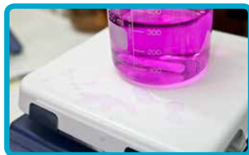
Piattello in vetroceramica a elevata resistenza chimica
