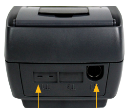
Connessione sonda esterna (Pt100 temperatura, CH 4 ...)
