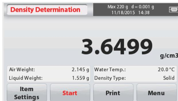
Drücken Sie auf **Start**, um alle Gewichtswerte zurückzusetzen und den Vorgang neu zu starten. Die Waage kann auch verwendet werden, um die Dichte eines schwimmfähigen Materials unter Verwendung von Wasser zu messen.
