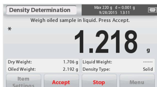
Sobald die erforderlichen Gewichte bestimmt wurden, wird die Dichte der Probe auf dem Anwendungsbildschirm in **g/cm<sup>3</sup>** angezeigt (zusammen mit dem Gewicht in der Luft und im Wasser).
