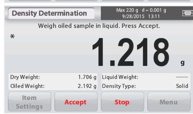
Una vez que se han determinado los pesos necesarios, se mostrará en pantalla la densidad de la muestra del líquido expresada en  $\text{g/cm}^3$  (junto con el peso en suspensión – en el aire, con aceite y sin aceite, y el peso en inmersión en el agua) en la pantalla de la aplicación(Applicationscreen).
