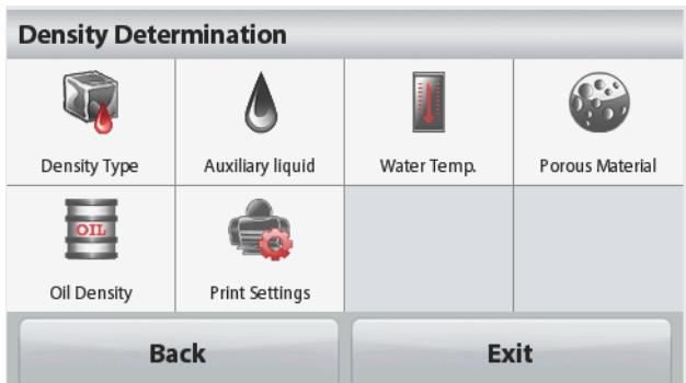
Para ajustar los valores de Temperatura del Agua, y/o de densidad del aceite, tocar los botones **[WaterTemp] – Temperatura del agua** [**OilDensity**] densidad del aceite.
