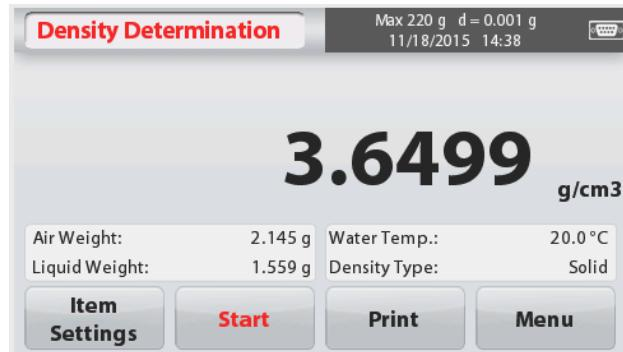
Premere **Iniziare** per reimpostare tutti i valori dei pesi e iniziare di nuovo il processo. La bilancia può anche essere utilizzata per misurare la Densità di un Materiale Galleggiante Utilizzando Acqua.
