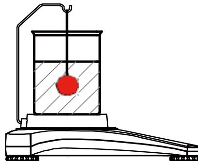
Sobald die erforderlichen Gewichte bestimmt wurden, wird die Dichte der Probe auf dem Anwendungsbildschirm in  $\text{g/cm}^3$  angezeigt (zusammen mit dem Gewicht in Luft und in Wasser).
