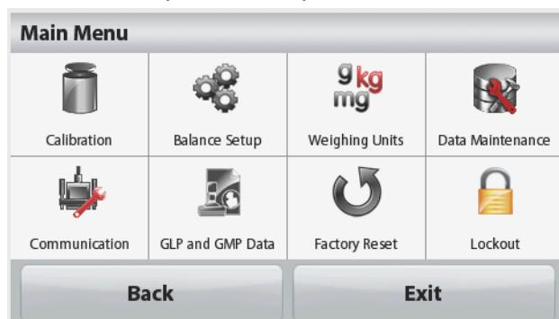
Lorsque l'interrupteur de sécurité est en position verrouillée, les menus d'étalonnage et de verrouillage sont masqués.
