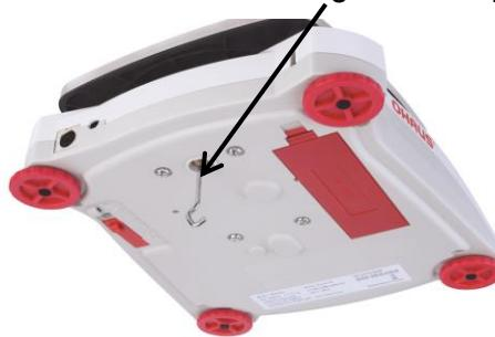
La balanza puede apoyarse mediante el uso de soportes de laboratorio o cualquier otro método adecuado. Asegúrese de que la balanza se encuentra nivelada y apoyada con seguridad y que el bloqueo de transporte ha sido anulado. Encienda la balanza, y use una cuerda o un alambre para fijar los elementos que deban de ser pesados.
