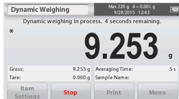
5. Cuando concluye la cuenta atrás, el resultado del pesaje se muestra y se mantendrá fijado en la pantalla.
