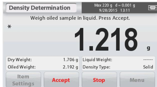
Una volta che i necessari pesi sono stati determinati, la densità del campione è visualizzata in **g/cm³** (insieme con il peso in aria, non-oliato e oliato, e peso in acqua) sullo schermo dell'Applicazione.
