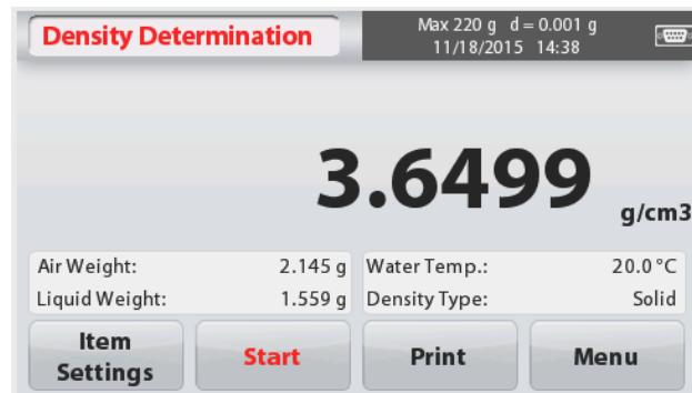
Pulsar **Start - Inicio** para reconfigurar / resetear (reset) todos los valores de pesaje y reiniciar el proceso.
