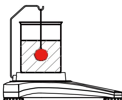
Lorsque les poids nécessaires ont été déterminés, la masse volumique de l'échantillon est affichée en **g/cm<sup>3</sup>** (avec le poids en milieu aérien, le poids immergé) sur l'écran de l'application.
