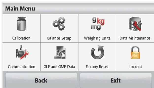
Cuando el interruptor de seguridad (Security Switch) está en la posición de bloqueo, los menús de Calibrado (Calibration) y de bloqueo (Lockout) permanecerán ocultos.
