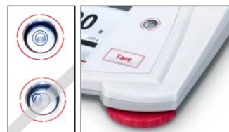
Compruebe la pantalla de asistencia al nivelado en el Menú de Configuraciones del usuario (UserSettingsMenu).
