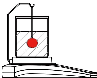
Una volta che i necessari pesi siano stati determinati, la densità del campione è visualizzato in **g/cm<sup>3</sup>** (insieme al peso in aria e peso in acqua) sullo schermo dell'Applicazione.
