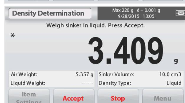
Una vez que se han determinado los pesos necesarios, se mostrará en pantalla la densidad de la muestra del líquido expresada en  $\text{g/cm}^3$  (junto con el peso en suspensión – en el aire, y el peso en inmersión en el agua) en la pantalla de la aplicación(Applicationscreen).
