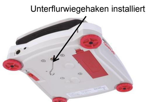
Die Waage kann mit Laborständern oder einer anderen geeigneten Methode gestützt werden. Stellen Sie sicher, dass die Waage eben und sicher steht, und dass die Transportsicherung freigegeben wurde. Schalten Sie die Waage ein, dann verwenden Sie eine Schnur oder einen Draht, um die Gegenstände zu befestigen, die gewogen werden sollen.
