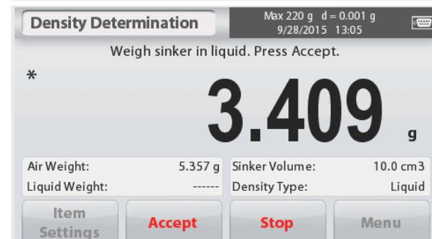
Lorsque les poids nécessaires ont été déterminés, la masse volumique de l'échantillon liquide est affichée en **g/cm<sup>3</sup>** (avec le poids en milieu aérien, le poids immergé) sur l'écran de l'application.
