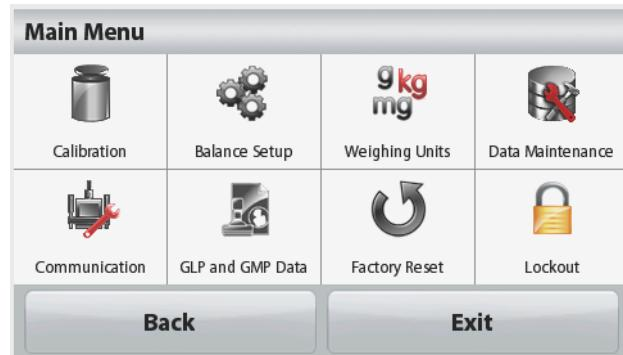
Wenn der Sicherheitsschalter in Sperrstellung ist, werden die Kalibrierung und die Sperrmenüs ausgeblendet.
