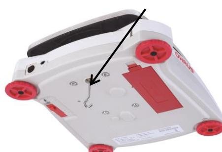
On peut soutenir la balance à l'aide de vérins de laboratoire ou autre méthode pratique. S'assurer que la balance soit de niveau et stable et que le verrou de transport ait été libéré. Mettre la balance sous tension, puis utiliser une chaîne ou un fil pour attacher les articles à peser.
