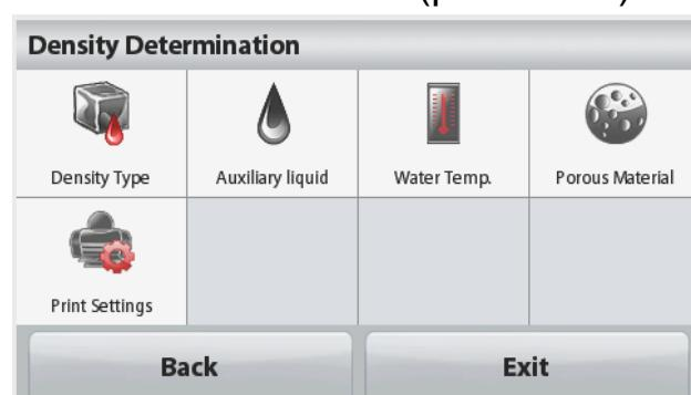
La balance calcule la masse volumique de l'eau sur la base de la valeur de température de l'eau saisie (de table de correspondance interne). Mesure la température réelle de l'eau en utilisant un thermomètre de précision.
