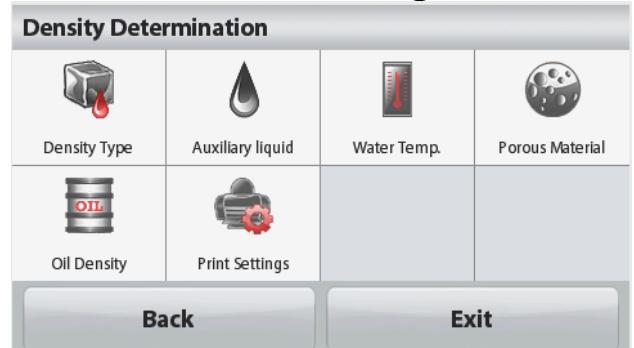
Um die Wassertemperatur oder die Öldichtewerte einzustellen, tippen Sie auf die Taste **Wassertemperatur** oder **Öldichte**.
