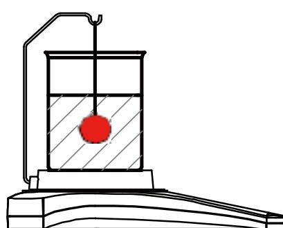
Una vez que se han determinado los pesos necesarios, se mostrará en pantalla la densidad de la muestra en  $\text{g/cm}^3$  (junto con el peso en suspensión – en el aire, y el peso en inmersión en el agua) en la pantalla de la aplicación(Applicationscreen).
