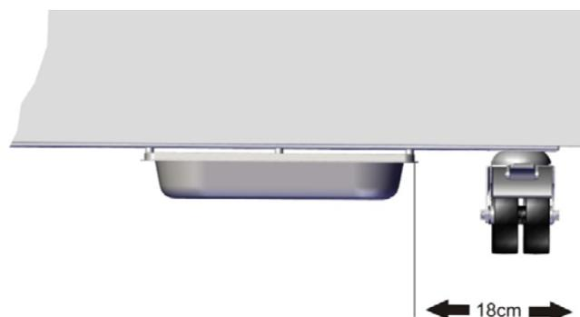
Figura 17: Posizionamento della vaschetta di raccolta per la condensa (vista anteriore)
