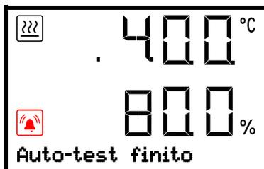
Visualizzazione del auto-test finito nella Vista iniziale (valori di esempio)
