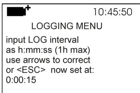
1. Tramite i tasti frecce **▲ ▼** selezionare la durata dell'intervallo che va da **un minimo di 2 secondi ad un massimo di un'ora**.
