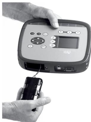
Lo strumento può essere alimentato da rete con, per esempio, l'alimentatore stabilizzato SWD10 ingresso 100÷240Vac uscita 12Vdc – 1A.
