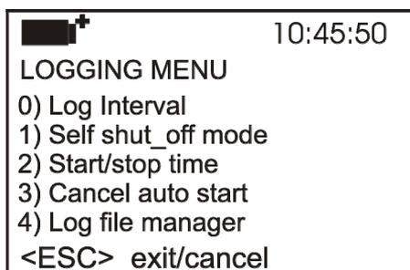
Si può impostare la cadenza di acquisizione dei dati (**Log interval**) e l'avvio automatico del logging (**Start/stop time**). **L'intervallo di acquisizione è unico per tutte le sonde.**
