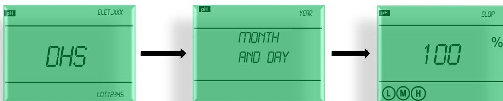
Informazioni visualizzate sul display quando si connette il sensore DHS --Modello --Lotto di produzione – Data ultima calibrazione – Slope %
