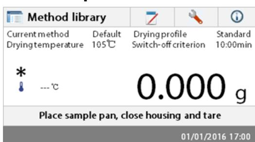
L'analizzatore è fornito con un metodo predefinito preinstallato. Seguire il messaggio di istruzione per avviare direttamente una misurazione. Premere l'area dei parametri per modificare.
