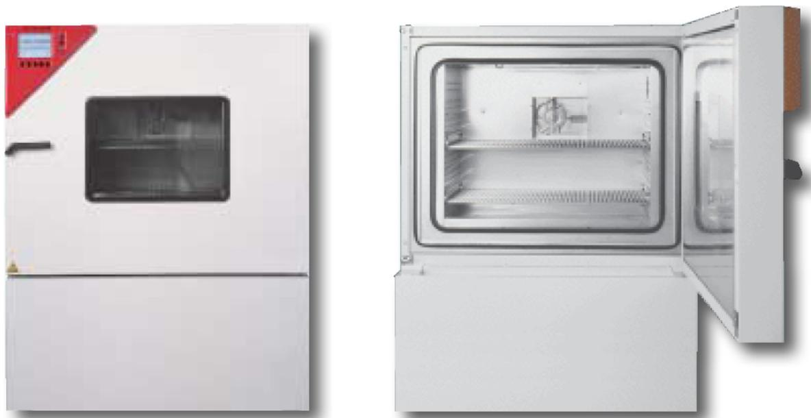
La **MKT 240** è una Camera per test di temperatura "Made in Germany" con un esteso **RANGE DI TEMPERATURA da -70°C a + 180°C** e un Volume interno utile di **240 Litri**. Lo strumento permette una precisa simulazione di temperature molto basse, dove sono richieste ottime performance di riproducibilità nei severi test per il controllo di qualità dei prodotti.
