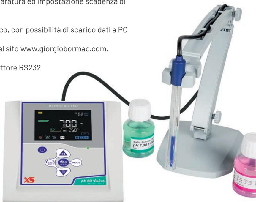
Con **solo 6 tasti** è possibile gestire facilmente le numerose funzioni dello strumento.
