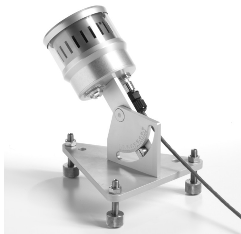
Fig. 3: installazione su base LP SD18.O
