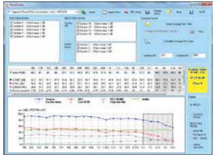
NS3 "Isolamento acustico": calcolo degli indici di isolamento per via aerea e da impatto.
