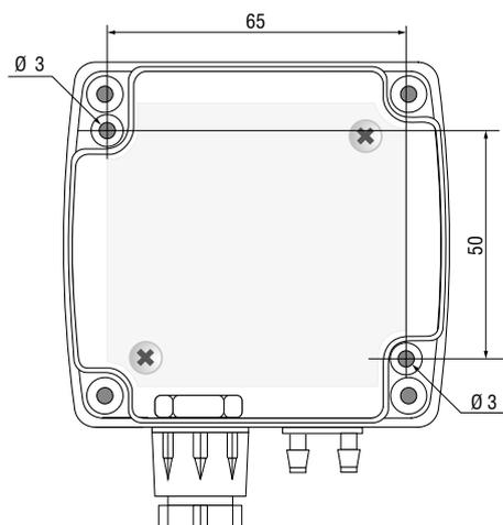
**Fig. 2: fori di fissaggio (dimensioni in mm)**
