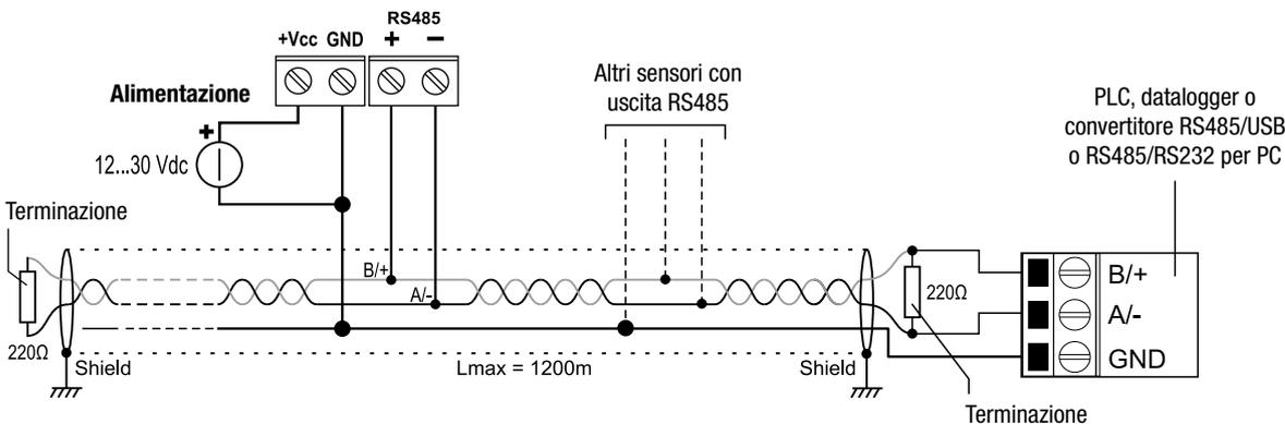
Fig. 6: Connessione RS485
