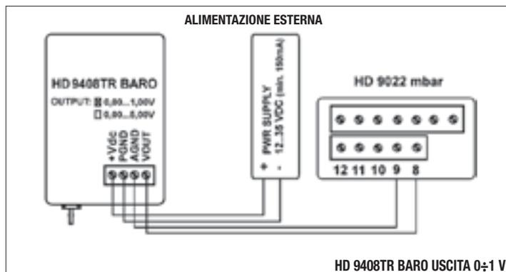
HD 9408TR BARO offre prestazioni in temperatura superiori: la circuiteria interna permette al sensore di lavorare a temperatura costante così che si ottiene una precisa compensazione termica sull'intero range da -40°C a +60°C.
