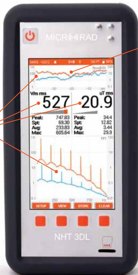
Tracciato di una componente FFT del campo elettrico e magnetico (esempio freq. 50 Hz)
