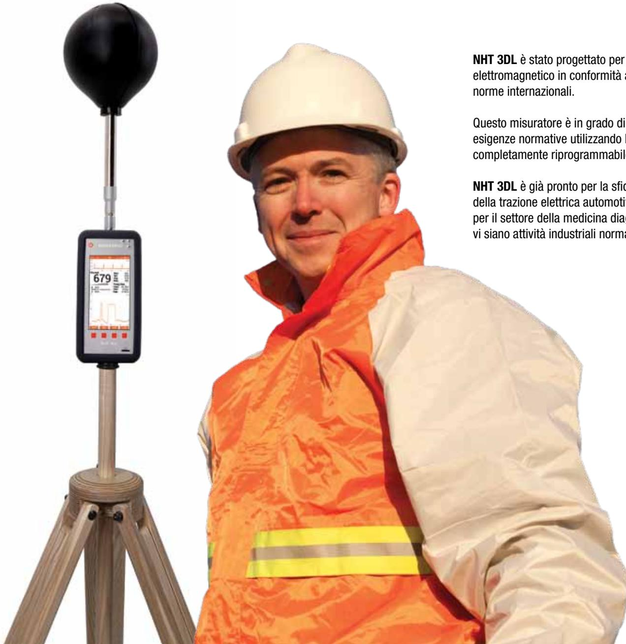
**NHT 3DL** è stato progettato per misure di campo elettromagnetico in conformità a tutte le principali norme internazionali.
