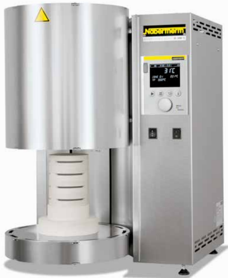
LHT 02/17 LB Speed equipaggiato con la funzione di raffreddamento rapido
