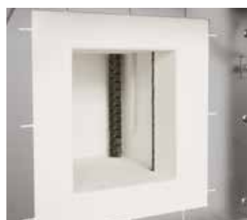
Camera forno con materiale in fibra pregiata e barre di riscaldamento SiC ai due lati
