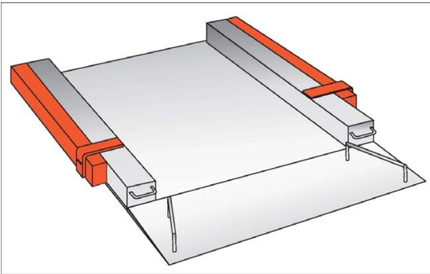
Dispositivo di sollevamento nella versione base con snodo di ribaltamento e cilindri a pressione di gas, per l'uso sono richieste due persone
