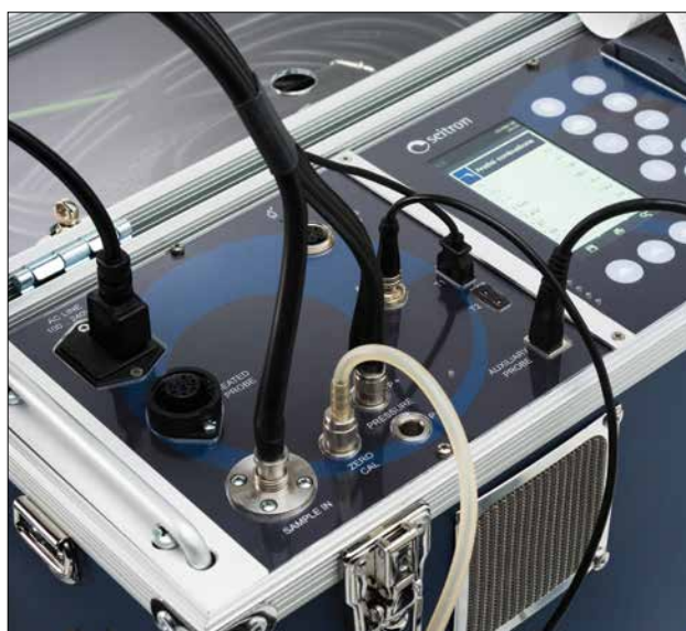
Pannello dei connettori
